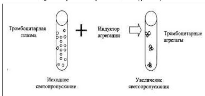
Рис. 120. Принцип работы агрегометра
