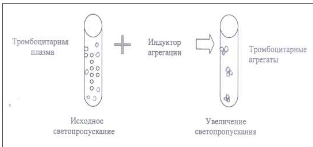
Рис. 86. Принцип работы агрегометра
